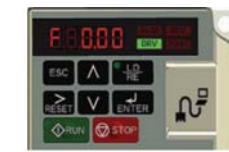
Figure 3: État sous tension de l'opérateur numérique du G+ Mini
